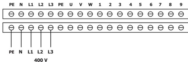
Подключение гидростанции производится четырехжильным кабелем сечением 1,5 мм<sup>2</sup>:
