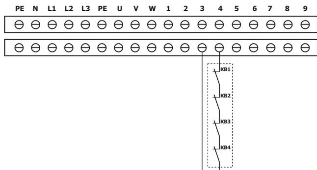
Подключите датчики безопасности двухжильным кабелем сечением 0,75 мм<sup>2</sup>.
